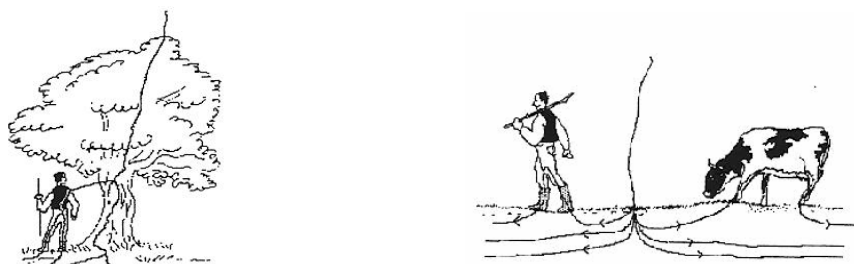
FIGURA 8 tensión de paso por impacto indirecto.
